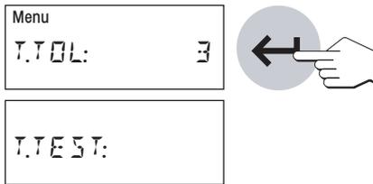
选择热输出的容许公差(根据本公司的质量管理体系确定)。使用HA-TCC温度校准盘, HR83可以保持 $\pm 3^{\circ}\text{C}$ 的公差。
